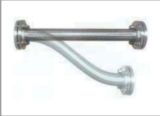
Fig. 1: 直式配管不銹鋼軟管不可作拉伸、或壓縮使用；但可橫向偏移。
