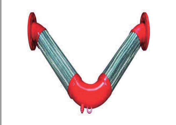
Fig. 3: V型最佳配管方式；V型不銹鋼軟管具有 X、Y、Z 三軸向位移作動。
