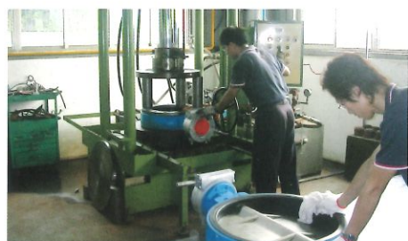
大型蝶閥試壓設備
